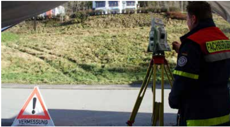
ESS-Messungen bei einem Hangrutsch.
